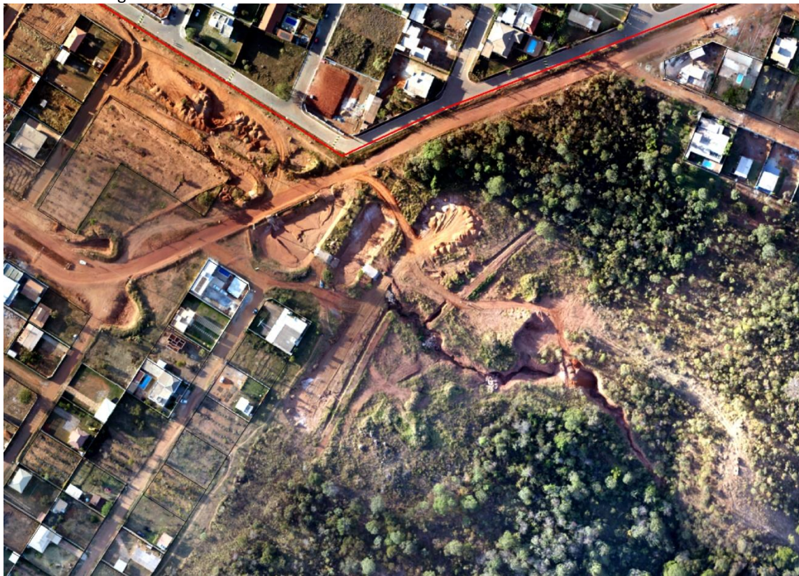
Figura 7 - Talvegue com existência de processo erosivo devido a concentração de água pluvial proveniente do condomínio
