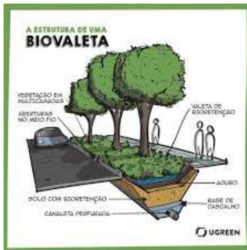
Figura 5: Esquema de uma biovaleta.
