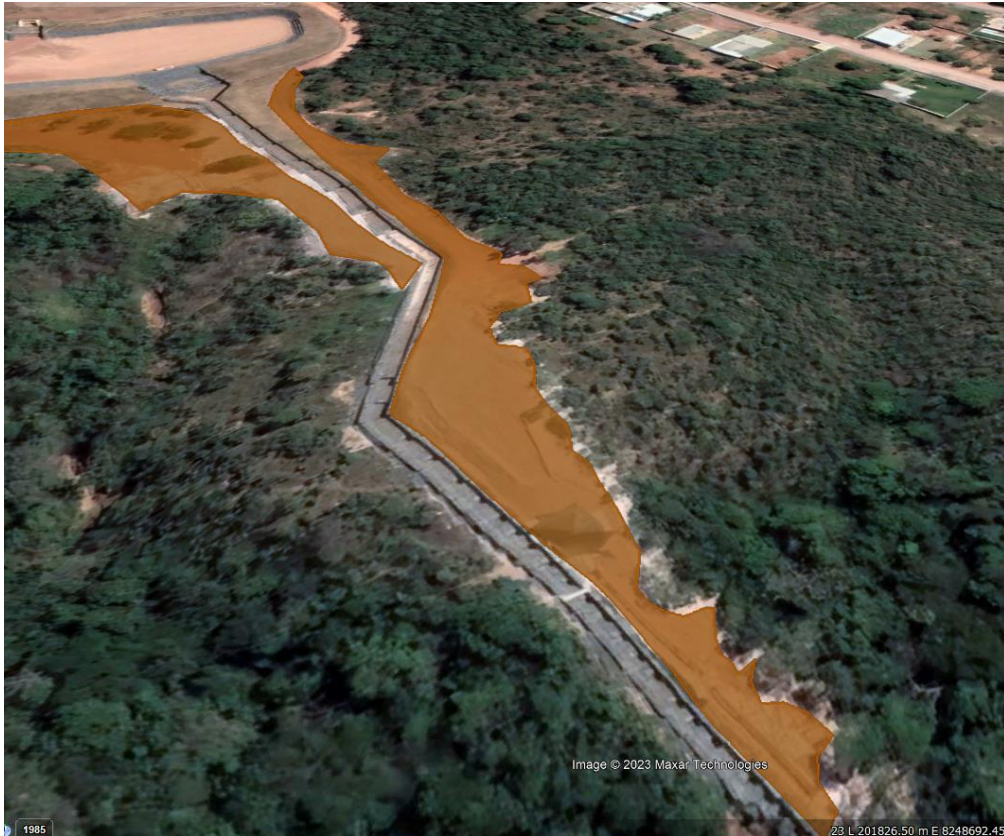
Figura 6 – Trechos que ainda não foram revegetados, considerando a movimentação de máquinas na faixa de serviço da obra – Imagem 02.
